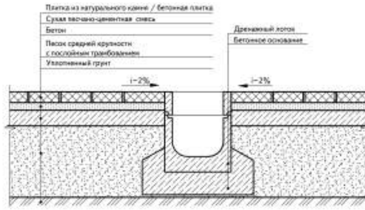
ИЛЛ. 1.2.13. ПРИНЦИПИАЛЬНАЯ СХЕМА УСТРОЙСТВА ЛИВНЕВОГО ВОДООТВОДА ПЕРПЕНДИКУЛЯРНО ПЕШЕХОДНОЙ ЗОНЕ
